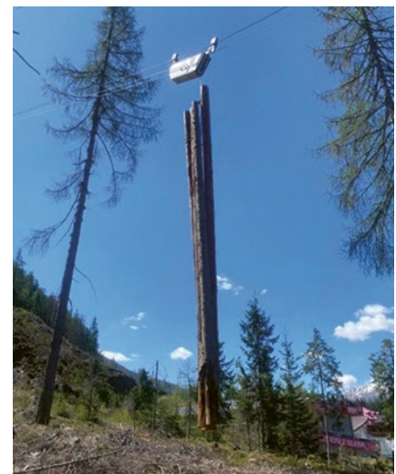
Akkubetriebener Laufwagen der Firma Ladstätter mit Holzlast bei der Bergabbringung
