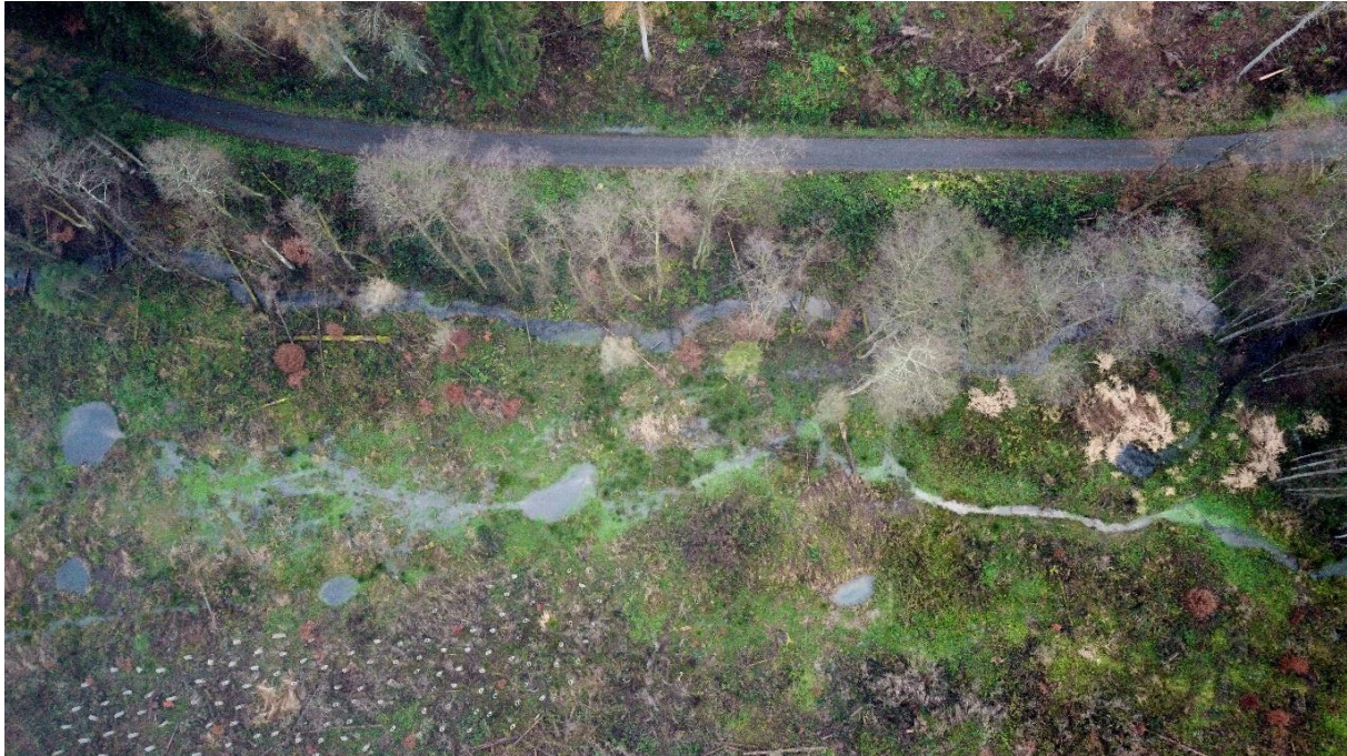
Abbildung 6: Renaturierung des Hainbaches und Anlage von Amphibien-Kleingewässern im Staatswald des FA Biedenkopf im Jahr 2022 (Luftbild), Verlangsamung des Wasserabflusses und höhere Versickerungsrate im betroffenen Areal
